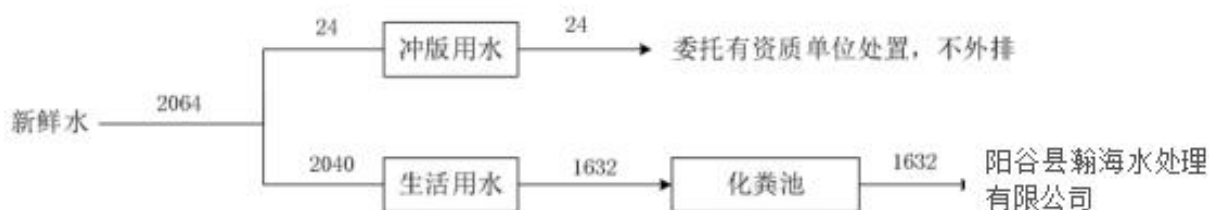
图 2-3 本项目水平衡图 ( \text{m}^3/\text{a} )
